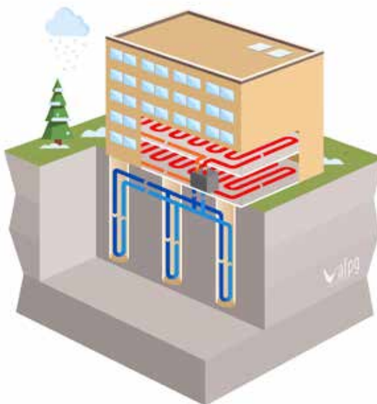
Figure 4 : Principe des fondations thermoactives
