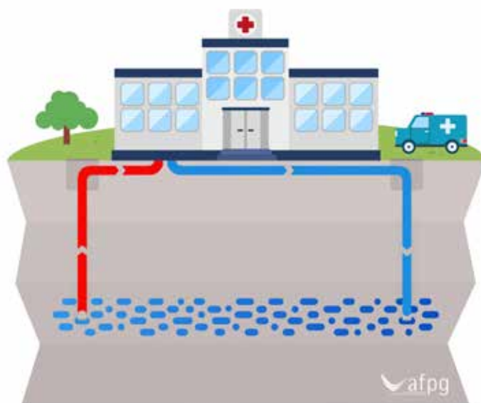
Figure 1 : Principe du captage sur nappes
