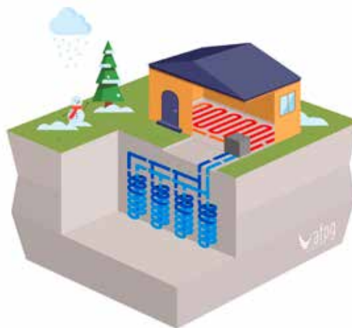
Figure 7 : Principe des corbeilles géothermiques
