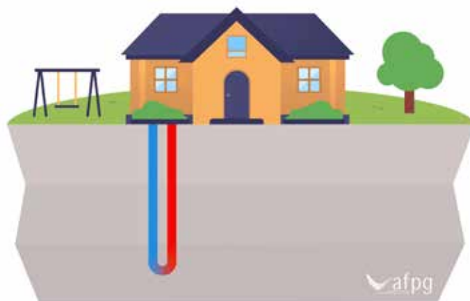
Figure 2 : Principe du captage par SGV
