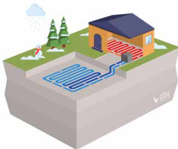
Figure 5 : Principe du captage horizontal
