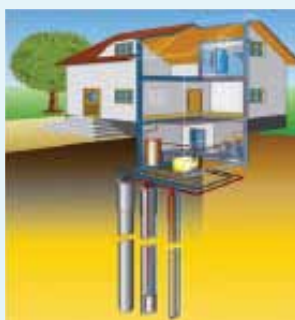
Sondes géothermiques verticales (SGV)
